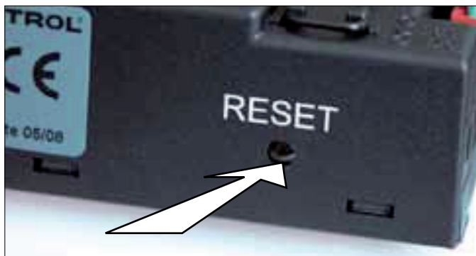
Abb. 9: Reset-Taste am Empfänger
